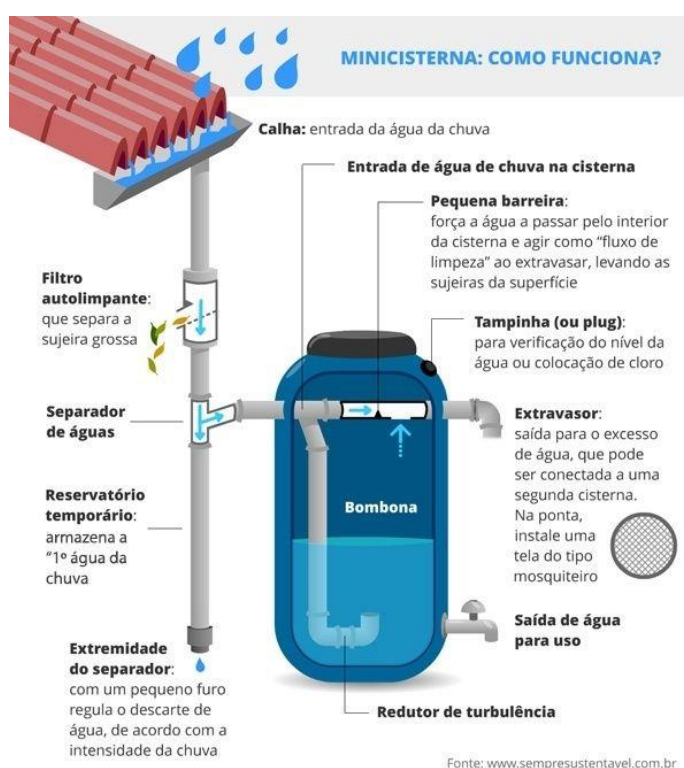
Figura 5- Exemplo de sistema de captação de água pluvial
