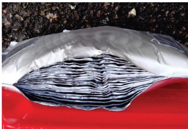
Figura 7: Ruptura de uma bateria de íon-lítio “pouch cell”.
