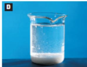
A reação entre o sulfato de alumínio e a cal hidratada (C) origina um precipitado branco (D).
