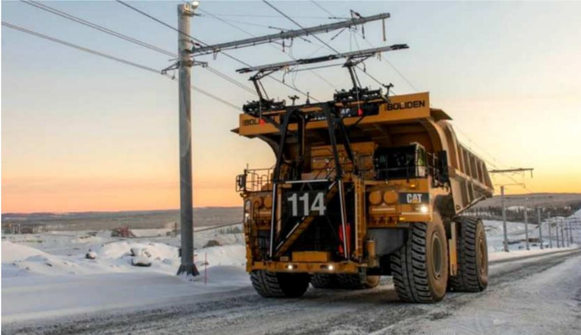
Figura 1 - Imagem caminhão Caterpillar 795F elétrico – Fonte – Site Catterpillar
