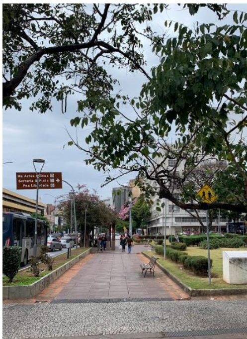
Figura 5-6 – Sinalização vertical obstruída por galhos de árvores – Trecho 1A.
