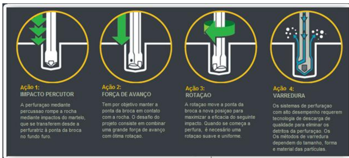
Figura 13 - Ações da perfuração percusso-rotativa
