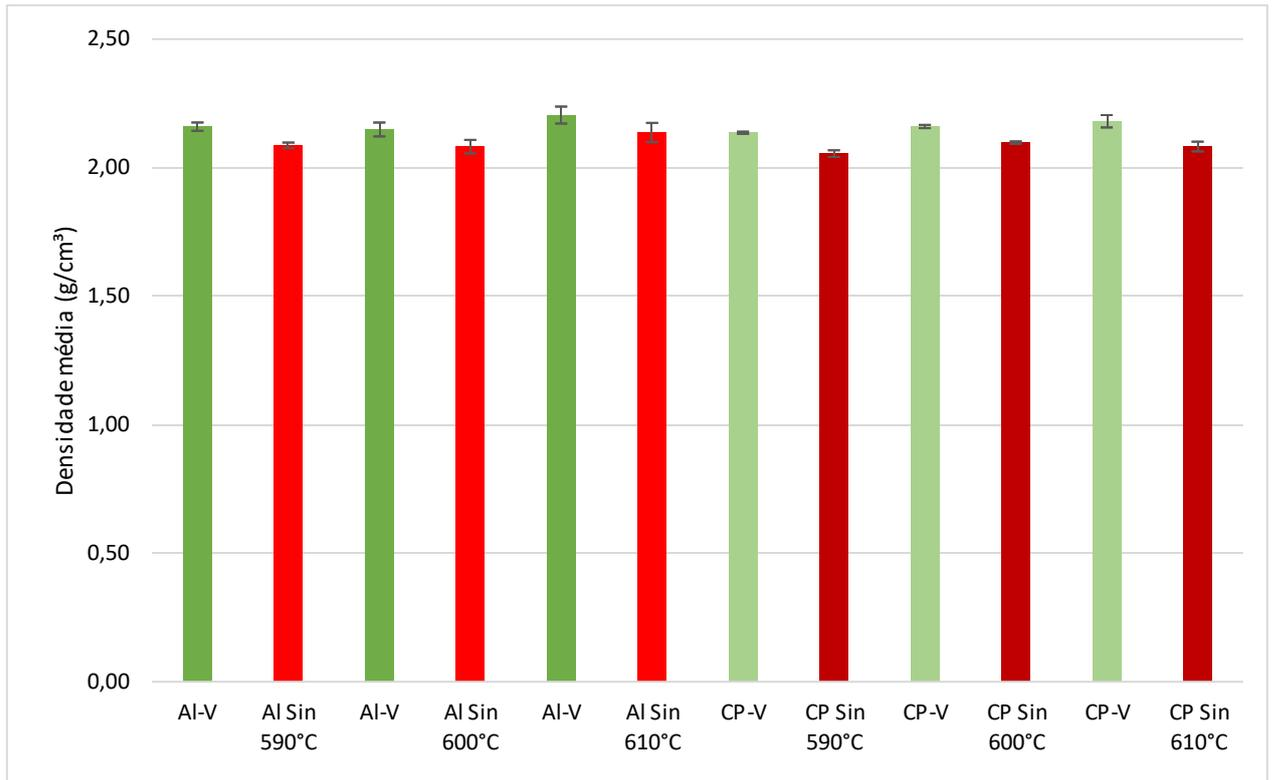
Figura 10 - Média dos valores de densidade geométrica. Cor verde: amostras verdes. Cor vermelha: amostras sinterizadas. Al-V: alumínio verde. Al-Sin: alumínio sinterizado. CP-V: compósito verde. CP-Sin: compósito sinterizado. Tempo de sinterização para todas as amostras: 2h
