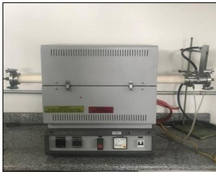
Figura 5 - Forno tubular utilizado no processo de sinterização
