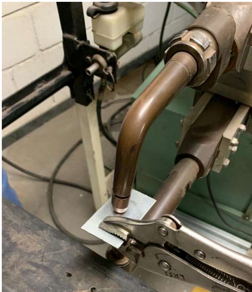
Figura 14: Soldagem do corpo de prova usado no ensaio de arrancamento do ponto de solda. Fonte: Pesquisa direta, 2022.
