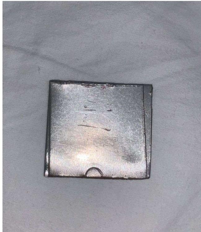
Figura 26: Corpo de prova cortado ao meio para melhor precisão na medição da lente de solda.
