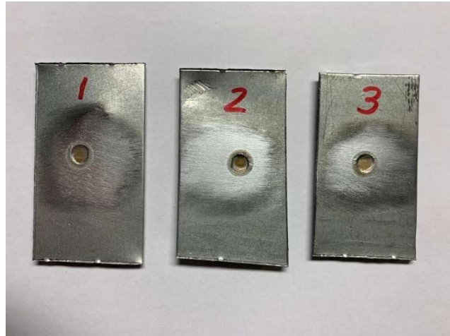
Figura 15 – Corpos de prova utilizados para testar qualidade da solda de acordo com a norma AWS D8.9M.
