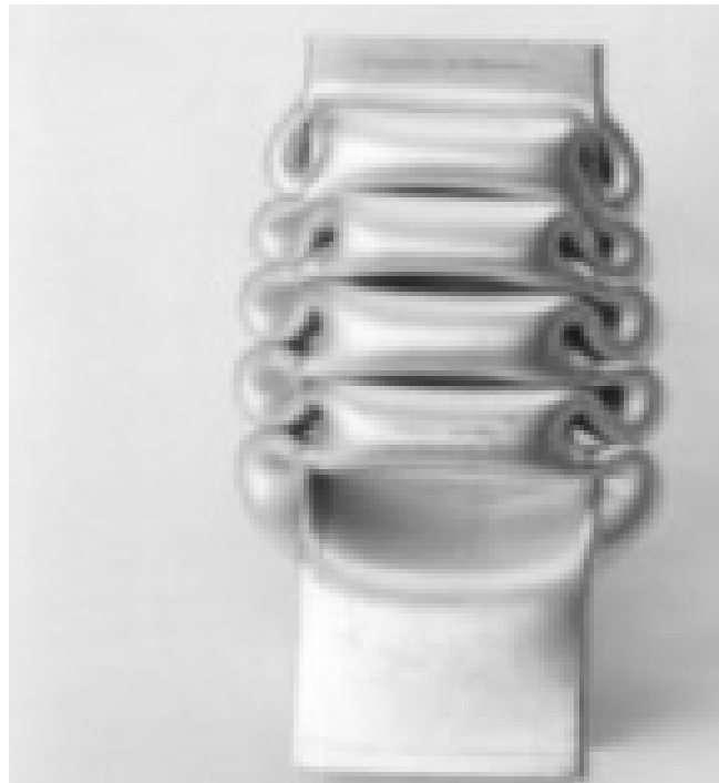
Figura 4 – Deformação axial de uma estrutura (coluna).
