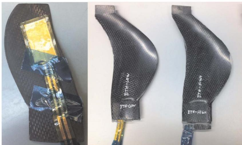
Figura 8: Instalação de PZT na lâmina de turbina.
