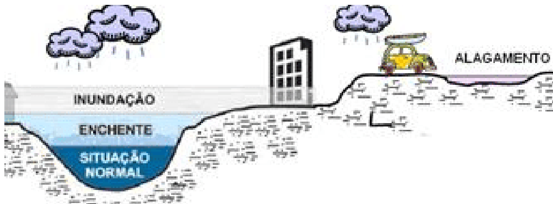
Figura 3 – Esquema dos quatro níveis de água atingidos por um curso d'água
