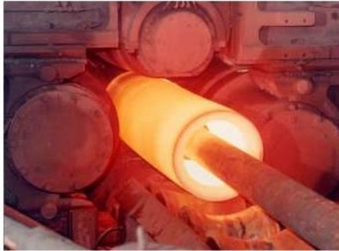
Figura 5: Processo de laminação para fabricação de tubos de aço sem costura. Fonte: Navarro (2019).
