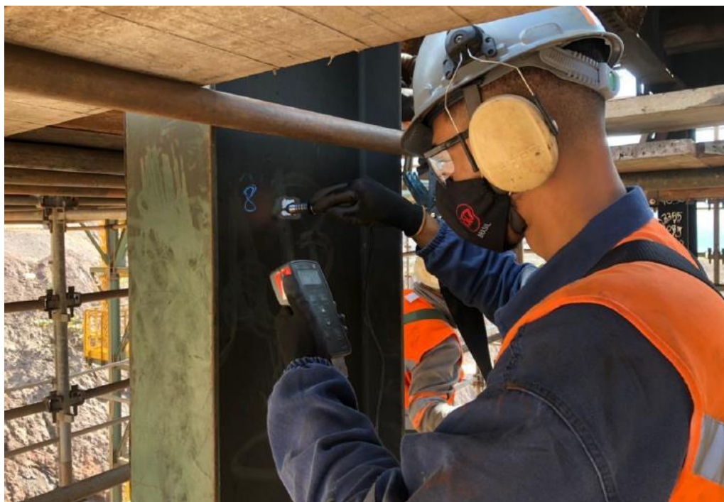
Figura 4 - Ensaio de dureza. Fonte: Pesquisa direta (2022).
