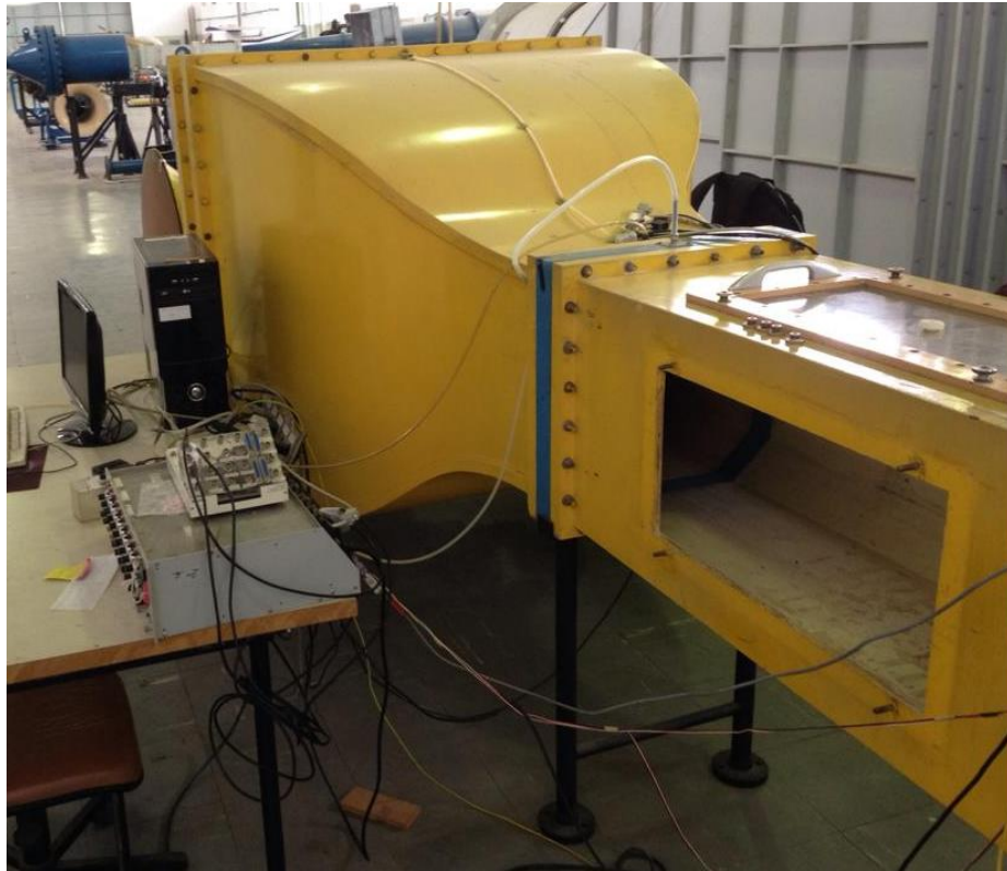
Figura 31: Túnel de vento Plint & Partners Ltd. com seção de testes aberta Fonte: Pesquisa Direta (2022)
