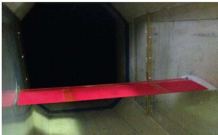
Figura 37: Matriz de ensaio posicionada no túnel de vento Fonte: Pesquisa direta (2022)
