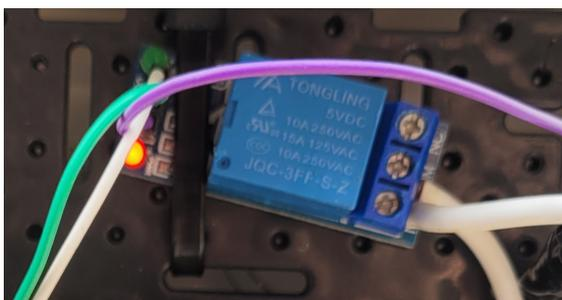
Figura 11 – Módulo rele de 1 canal
