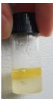
Figura 7 - Frasco iniciado dia 19, porém não pesado por apresentar características diferentes na seringa coletora, pipeta de Pasteur e no frasco acondicionador (vide líquido com aparência emulsionada abaixo do óleo essencial)
