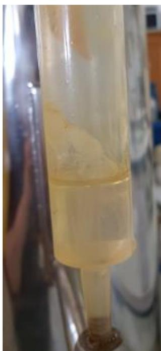
Figura 29 - Seringa coletora do aparelho destilador com camada formada durante o processo de extração a partir do dia 13 e a partir de 3h do processo
