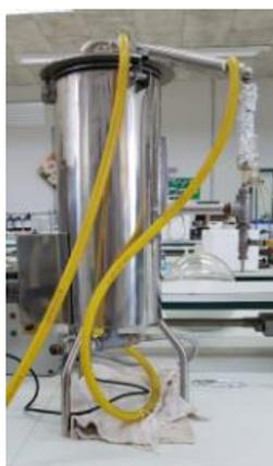
Figura 3 - Detalhe do destilador com seringa lateral durante processo de destilação, com seringa lateral coberta com papel alumínio.
