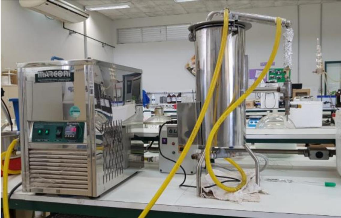
Figura 2 - Aparelho destilador composto por bomba de refrigeração de água, bomba de aquecimento de água e destilador (corpo, condensador e seringa coletora, que se encontra coberta por papel alumínio) (Acervo Pessoal)
