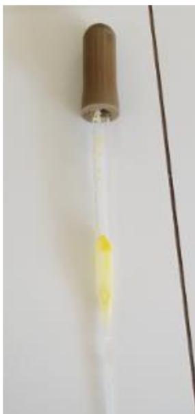
Figura 28 - Pipeta de Pasteur de vidro com camada amarela que surgiu na seringa coletora do aparelho destilador a partir do dia 13 e a partir de 3h do processo de extração
