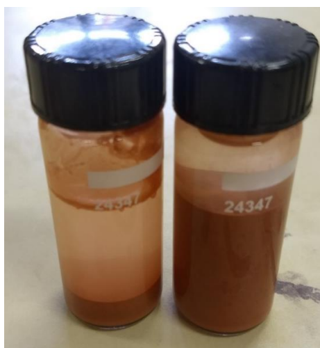
Figura 22 – Processo de decantação, à direita amostra de filtrado com 15% de sólidos e à esquerda a amostra de filtrado com 20% de sólidos.
