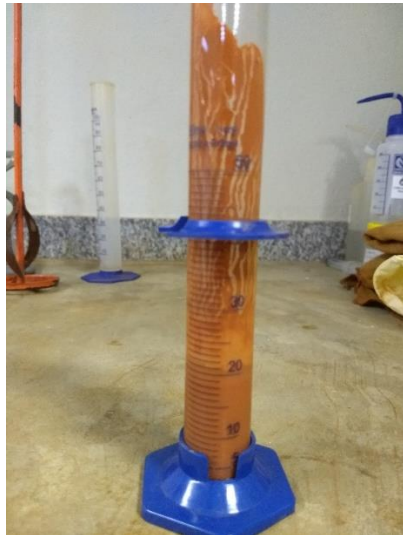
Figura 20 – Filtrado obtido com geotêxtil tecido e teor de sólidos a 25%.
