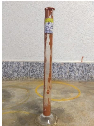
Figura 21 – Filtrado obtido com geotêxtil tecido e teor de sólidos a 42,3%
