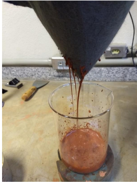
Figura 16 – Comportamento filtrante Teor de sólidos a 15%, decorridos menos de 1 minuto do início do ensaio.
