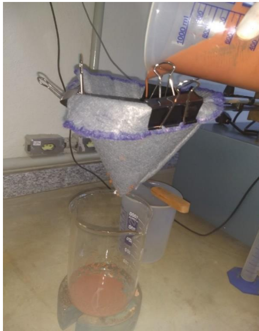
Figura 12 – Início do ensaio de cone – despejamento do rejeito no geotêxtil filtrante.
