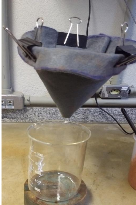
Figura 10 – Montagem do filtro com geotêxtil não-tecido
