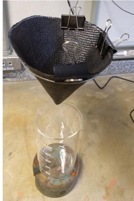
Figura 11 – Montagem do filtro com geotêxtil tecido
