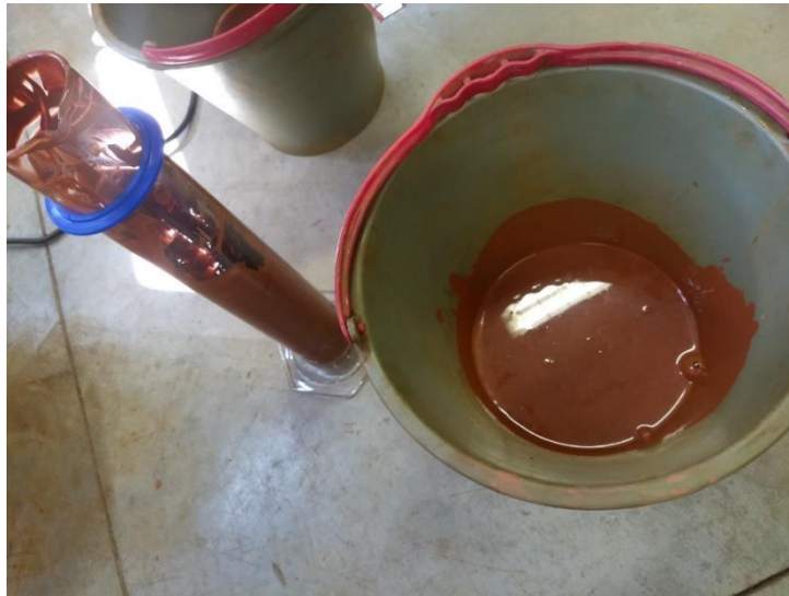
Figura 9 – Amostra de 1 litro de rejeito retirada do tambor de 20 litros e colocada em baldes para pesagem e acréscimo de água.
