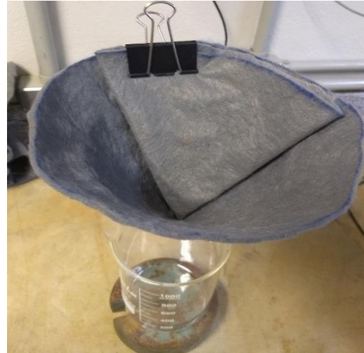
Figura 8 – Dobra final do geotêxtil com respectiva vista superior do filtro em cone
