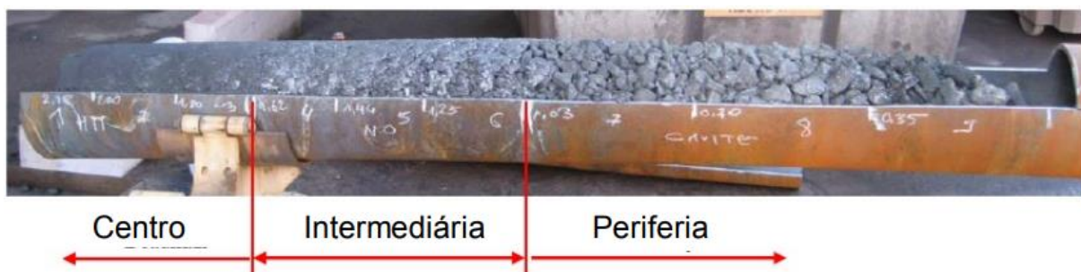
Figura 3.6: Amostra do núcleo do homem morto através das ventaneiras
