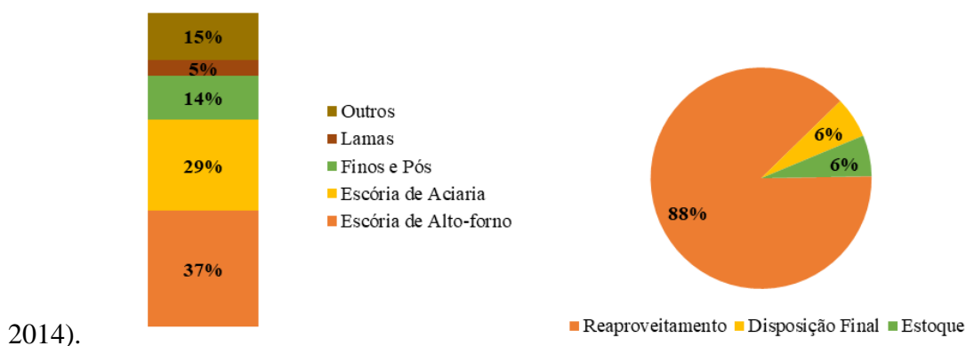
Figura 1.1: Percentual dos tipos de resíduos gerados pela indústria siderúrgica brasileira no ano de 2013 (INSTITUTO AÇO BRASIL, 2014).
