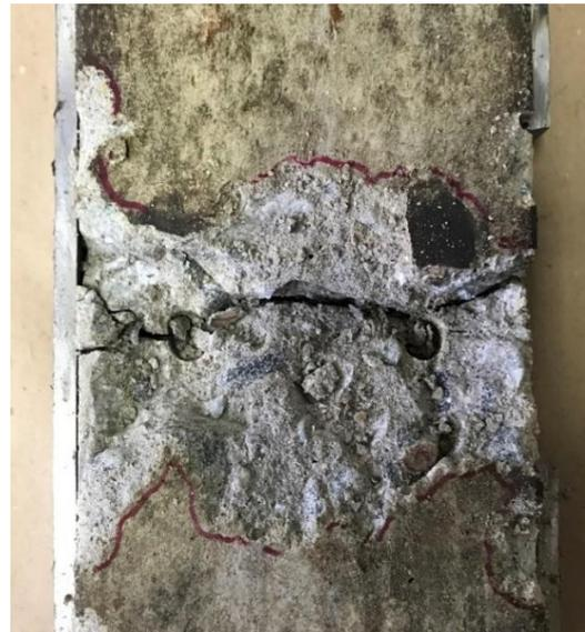
(b) Corte na região do concreto para identificar o modo de falha.
