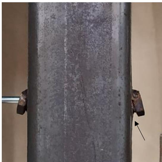
Figura 28 – Amassamento da parede do tubo de aço para o protótipo 4P(10r)-t4,75\*.
