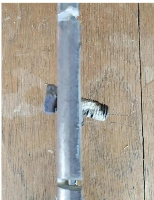
(c) Flexão do parafuso de 10 mm
