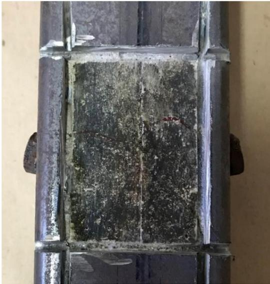
(a) Corte da parede do tubo para identificar o rompimento do corpo de prova
