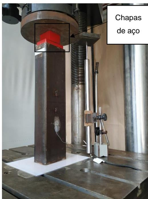
Figura 15 – Utilização das chapas de aço como mecanismos de transmissão de carga durante o ensaio.
