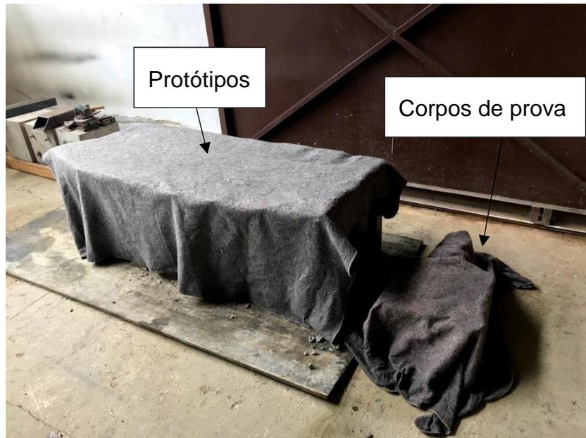
Figura 14 – Cura dos protótipos e dos corpos de prova com manta úmida.
