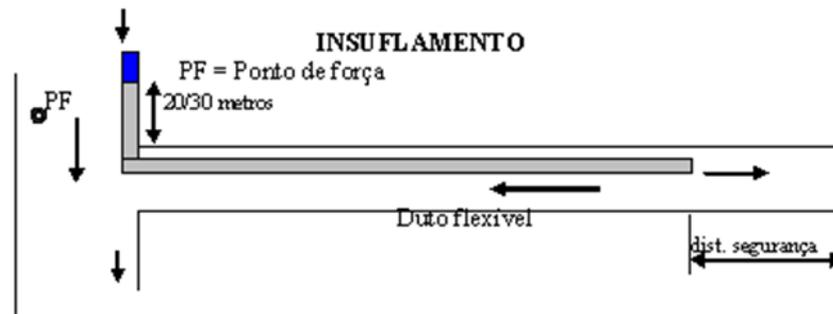
Figura 1 – Esquema de ventilação por insuflamento
