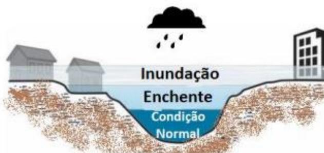
**Figura 9 - Perfil esquemático do processo de enchente e inundação. Fonte: Adaptado de Min. Cidades/IPT (2007)**
