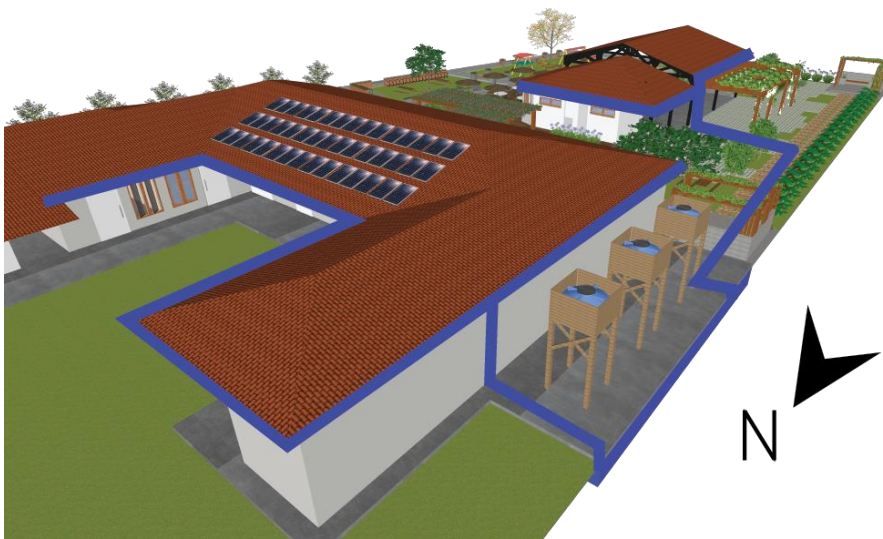
Figura 31: Diagrama de energia solar e captação de água da chuva.
