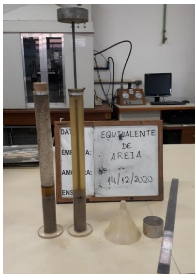
Figura 11 – Ensaio Equivalente de areia (Silva e Viana, 2021)
