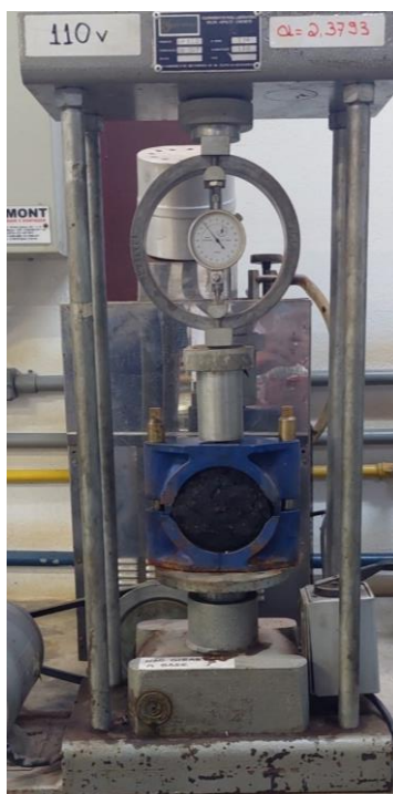
Figura 19 – Execução do ensaio de Estabilidade e Fluência Marshall (arquivo pessoal)
