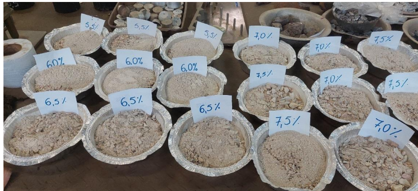
Figura 15 – Separação da massa dos agregados para cada teor de ligante asfáltico (arquivo pessoal)
