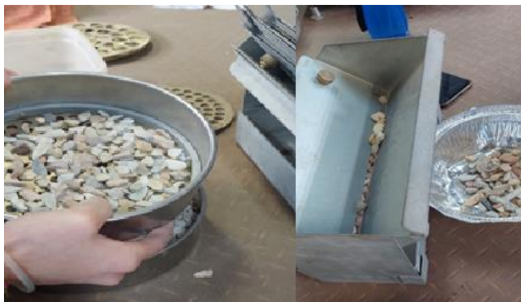
Figura 12 – Peneiramento do material com crivos de abertura circular e passagem pelos crivos redutores (arquivo pessoal)
