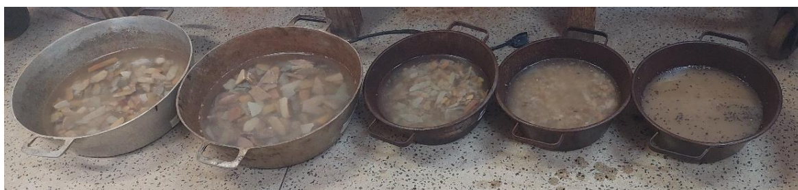
Figura 8 – Material preenchido por água para a determinação da absorção do quartzito foliado (arquivo pessoal)
