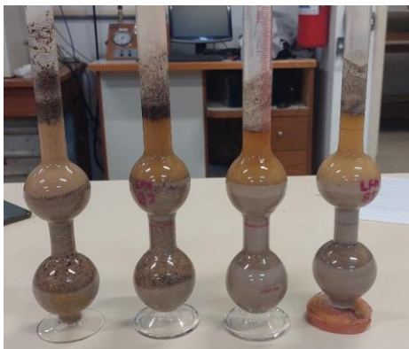
Figura 10 – Execução do Ensaio de Massa Específica dos agregados miúdos através do frasco de Chapman (arquivo pessoal)
