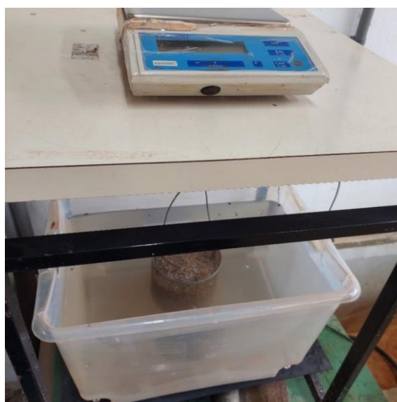
Figura 9 – Ensaio para a determinação da massa hidrostática do quartzito (arquivo pessoal)
