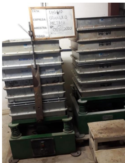
Figura 6 – Análise granulométrica do quartzito (Silva e Viana, 2021)
