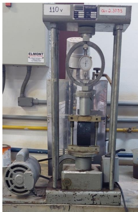
Figura 17 – Execução do ensaio RT (arquivo pessoal)
