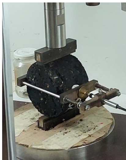
Figura 18 - Execução do Ensaio de Módulo de Resiliência (arquivo pessoal)
