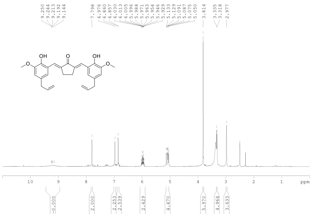
Espectro de RMN de ^1\text{H} do derivado 11 ( \delta , \text{DMSO}-d_6 , 400 MHz).
