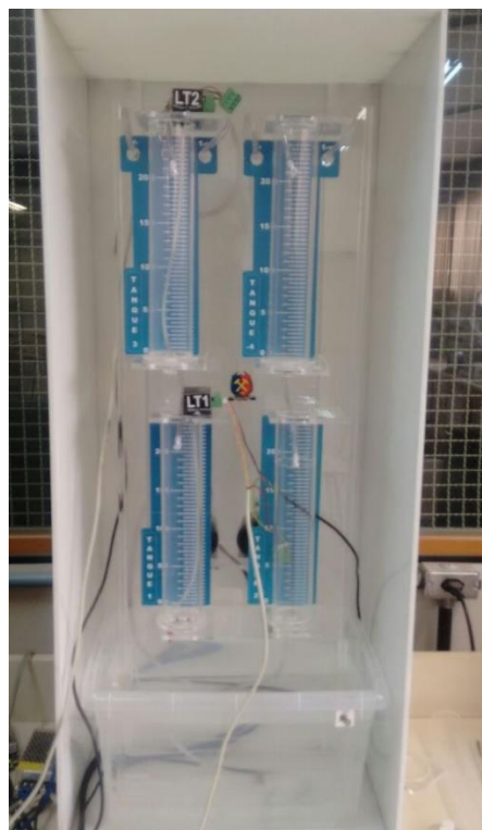
Figura 1.1 Bancada de Tanques Acoplados
