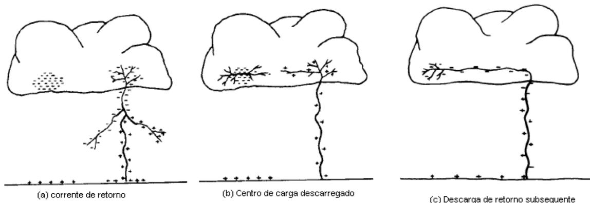
Figura 2-5-- Representação esquemática de Descarga de Retorno
