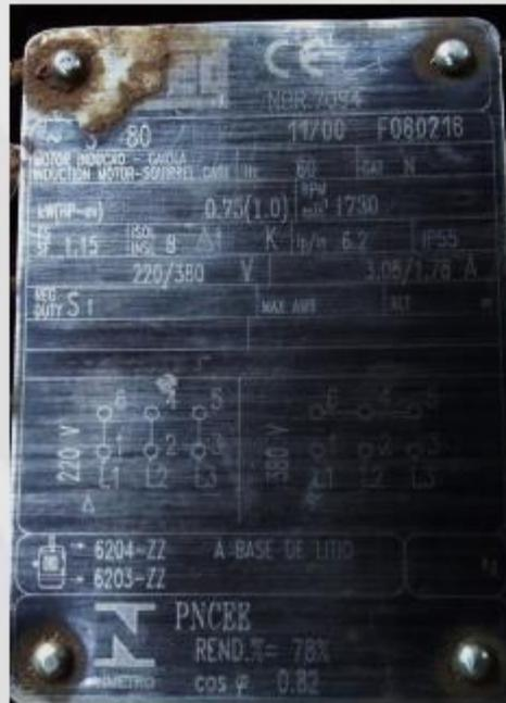
Figura 3 - Placa do motor
