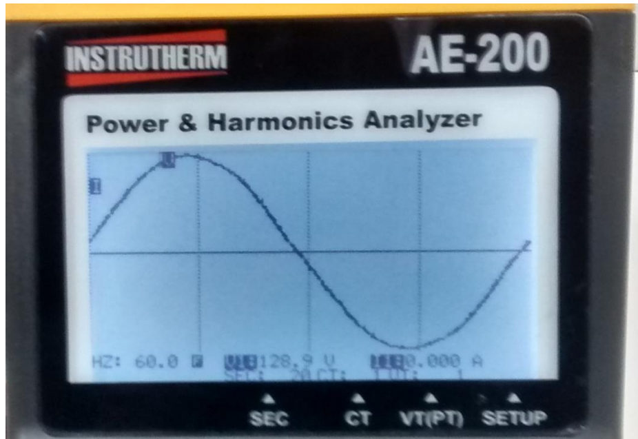
Figura 4.6: Forma de onda sem distorção harmônica, senoide perfeita.
