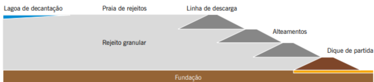
Figura 1 - Método de alteamento a montante (IBRAM, 2016).
