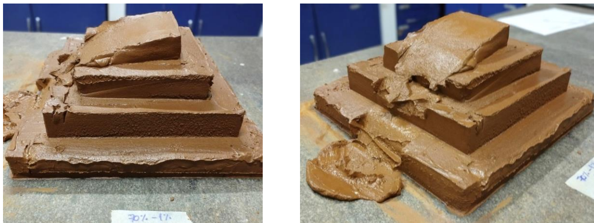
Figura 38 – Pilha RBMF-70-1-4 ao final do ensaio de ruptura.
