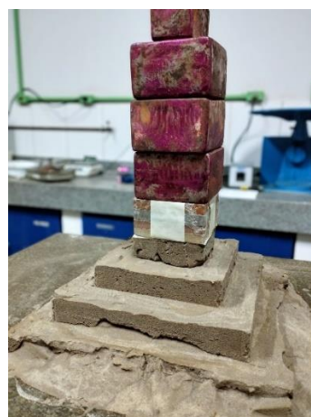
Figura 15 – a) Peso fixo de 1 kg; b) Ensaio de ruptura com peso igual a 18 kg.
