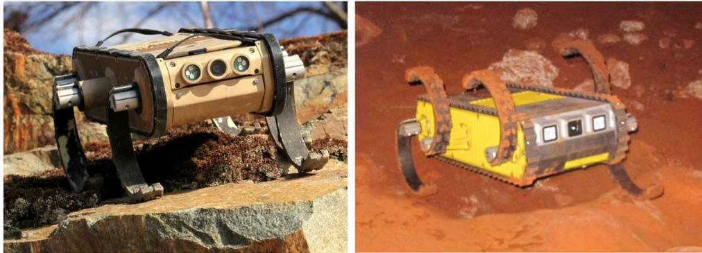
Figura 3 – Comparação entre as morfologías do RHex (esquerda) e Espeleorobô (direita). Fonte: ROCHA (2018).
