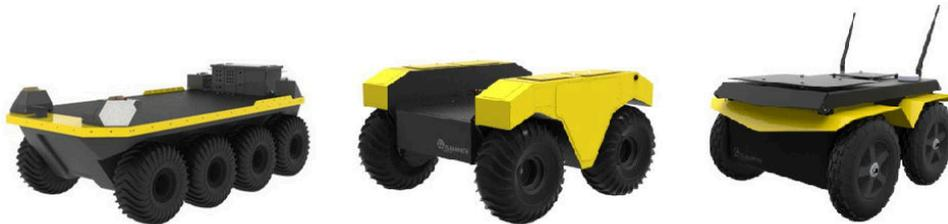
Figura 6 – Moose UGV (esquerda), Warthog UGV (centro) e Jackal UGV (direita). Fonte: [ROBOTICS \(2022c\)](#).
