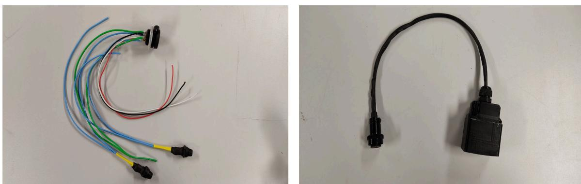
Figura 66 – Conectores de recarga interno (esquerda) e externo (direita). Fonte: O autor.
