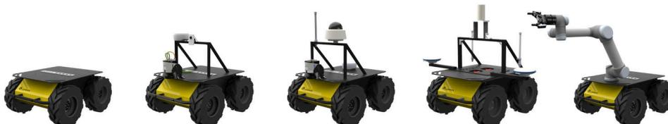
Figura 7 – Husky UGV em suas versões *starter*, *explorer*, *explorer pro*, *mapping* e *manipulator*, respectivamente. Fonte: [ROBOTICS \(2022d\)](#) - Adaptado.
