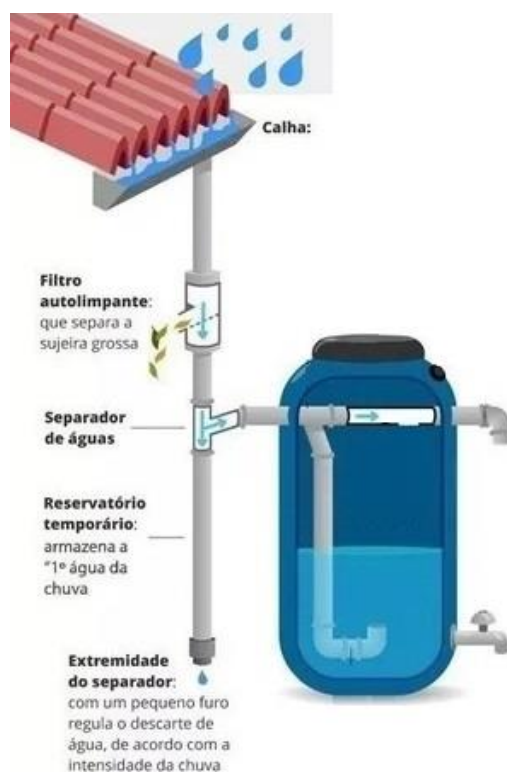
Figura 6 - Representação de Filtro e dispositivo de descarte de água inicial
