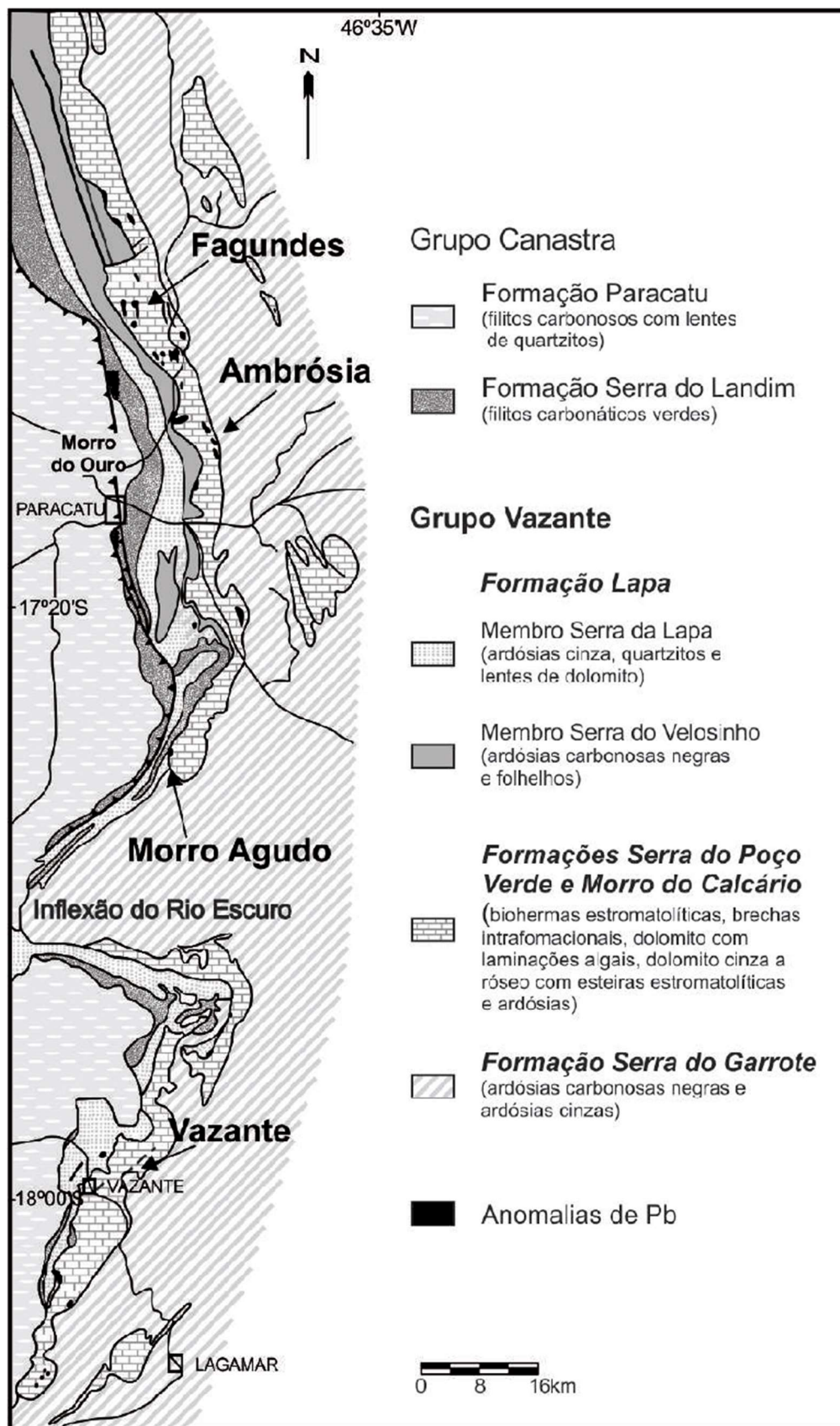
Figura 3.1 - Mapa regional dos grupos Vazante e Canastra com a localização dos depósitos de Vazante, Morro Agudo, Ambrósia e Fagundes (adaptado de Monteiro 2006).
