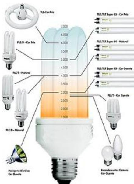
**FIGURA 2.16 - Imagem ilustrativa de uma lâmpada fluorescente compacta.**
