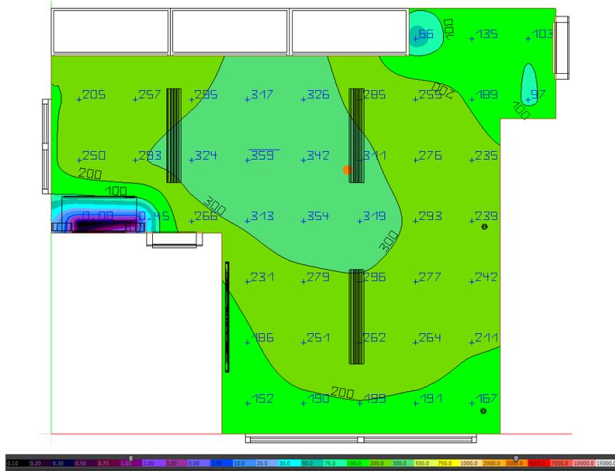
**FIGURA 4.7 - Níveis de iluminância em linhas isométricas, cores falsas e ponto a ponto do dormitório da suíte 1.**
