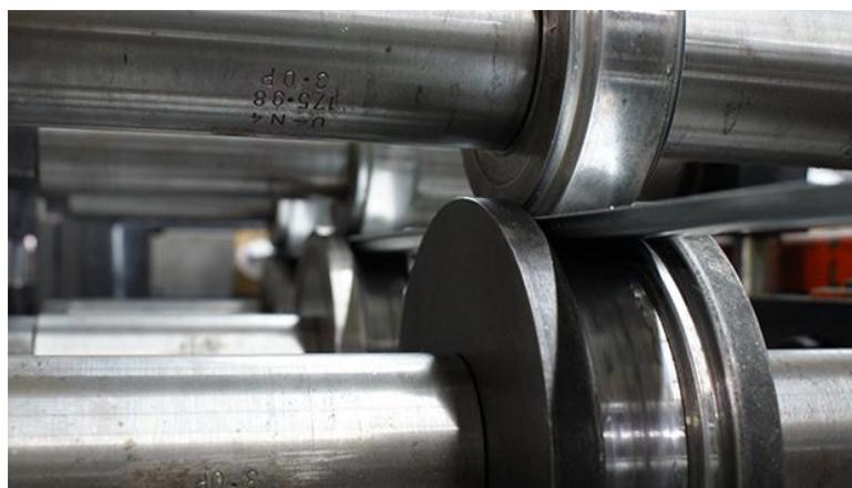
**Fig. 3 - Processo de perfilação**
