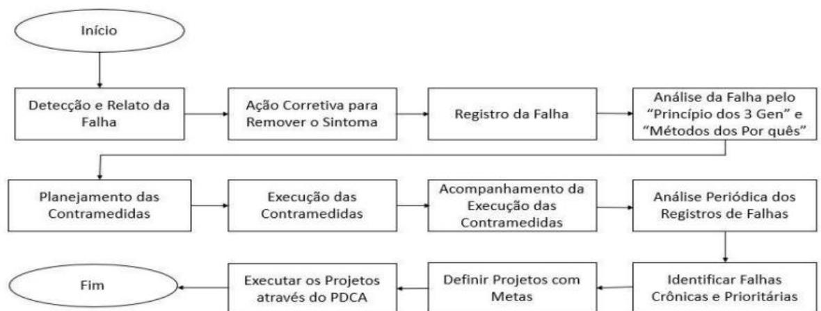
Figura 1 - Fluxograma tratamento de falhas
