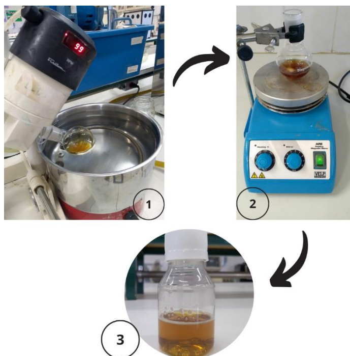
Figura 7- Processo para a realização do hidrogel. 1- Processo de evaporação do solvente utilizado para solubilizar o extrato; 2- Adição da água e homogeneização da formulação com auxílio da chapa magnética; 3-Armacenamento da formulação em um recipiente de plástico.
