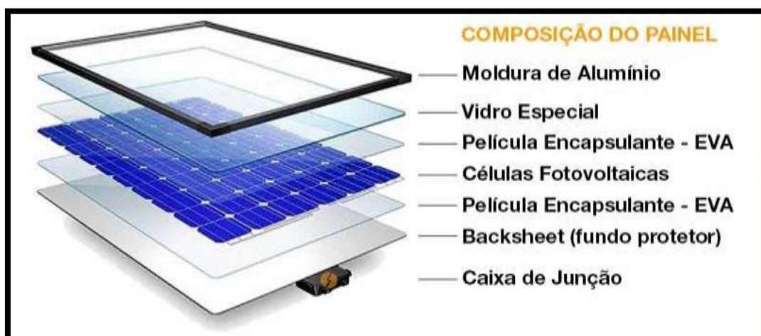
Figura 10: Composição do Painel Fotovoltaico
