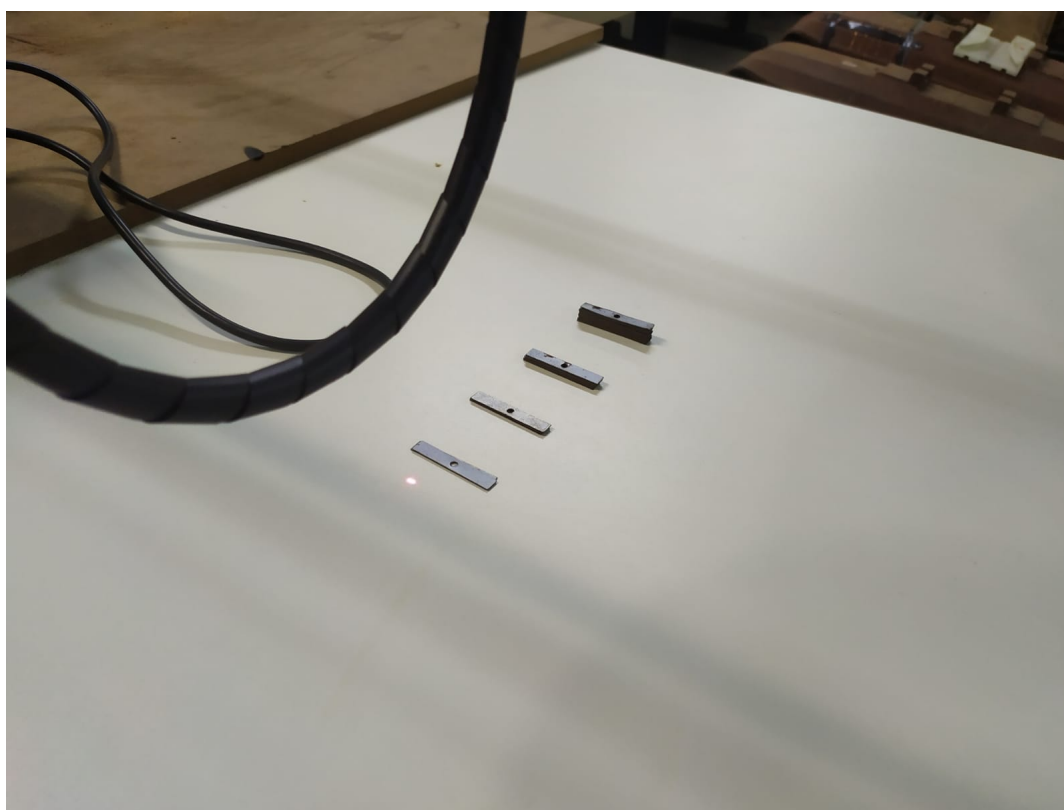
Figura 61 – Teste da resolução do sensor com as chapas de aço.
