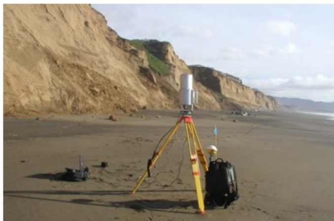
Figura 1 – Escâner 3D baseado em aquisição a laser fazendo o mapeamento de um talude.
