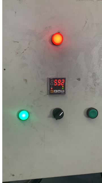
Figura 14 – Painel ajustável das máquinas de trefilação.
