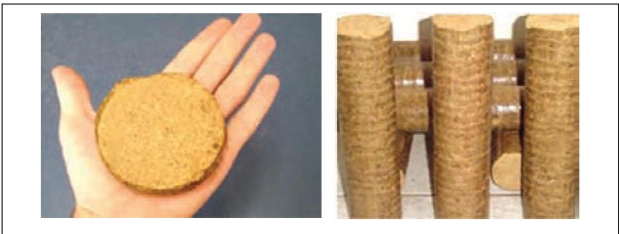
Figura 14: Briquetes em forma de bolacha e tarugos.
