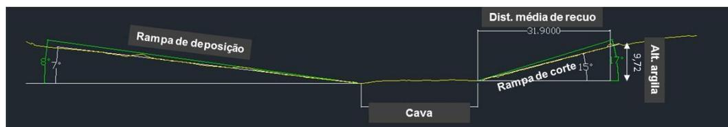
Figura 18 – Perfil de uma das tiras analisadas (AUTOCAD)
