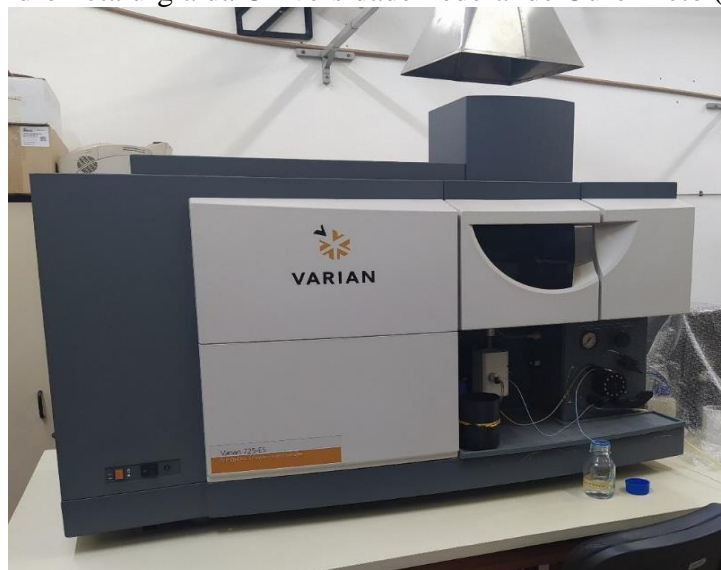
Figura 4.4 – ICP-OES da marca Varian ® , modelo 725/ES do Laboratório de Bio&Hidrometalurgia da Universidade Federal de Ouro Preto (UFOP).
