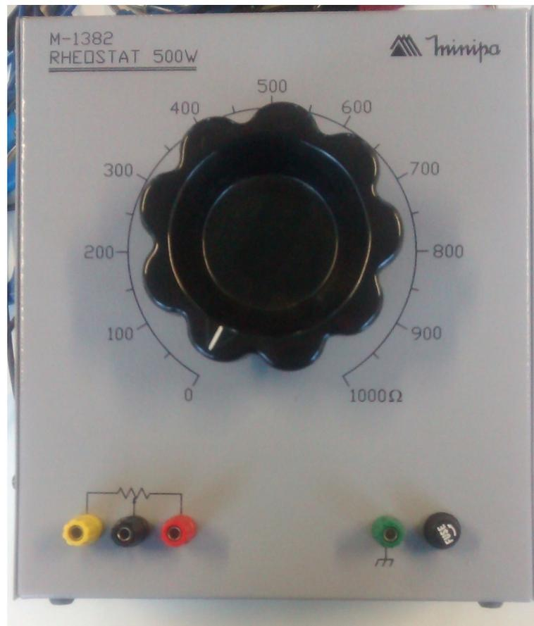
Figura 45 – Foto do Reostato
