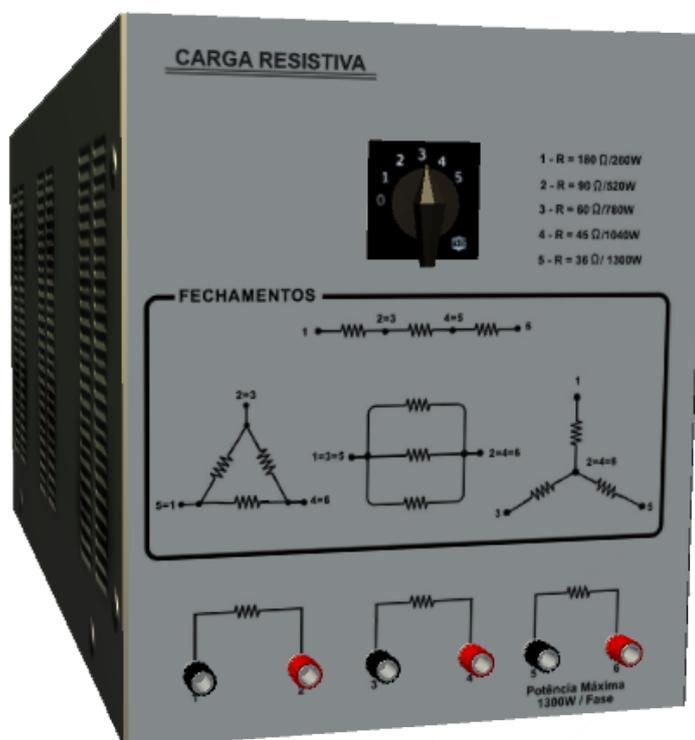
Figura 43 – Objeto 3D referente da carga resistiva
