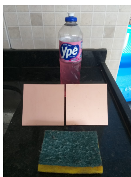
(b) Limpeza da PCI.
