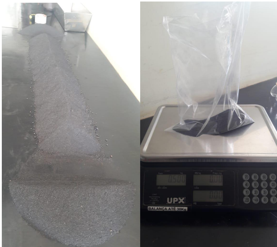
Figura 31 - Quarteamento em bancada e pesagem das alíquotas
