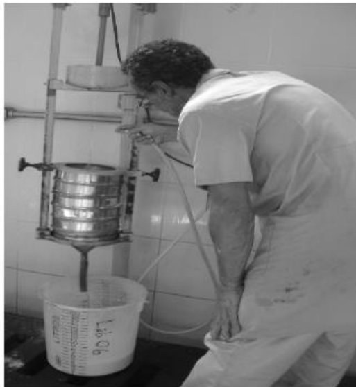
Figura 12 - Peneiramento a úmido, em escala de laboratório
