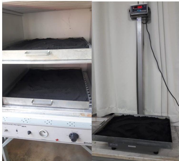
Figura 28 - Secagem em estufa e pesagem as amostras
