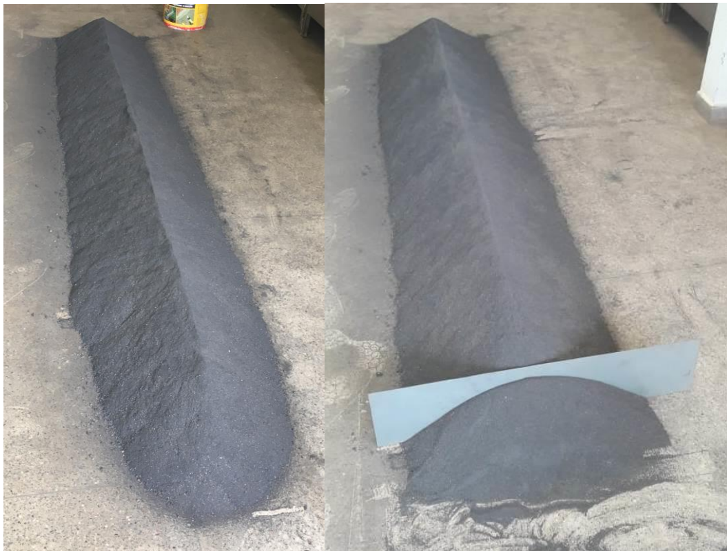
Figura 30 - Pilha alongada final e quarteamento da pilha alongada
