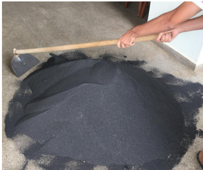
Figura 29 - Homogeneização em pilha cônica
