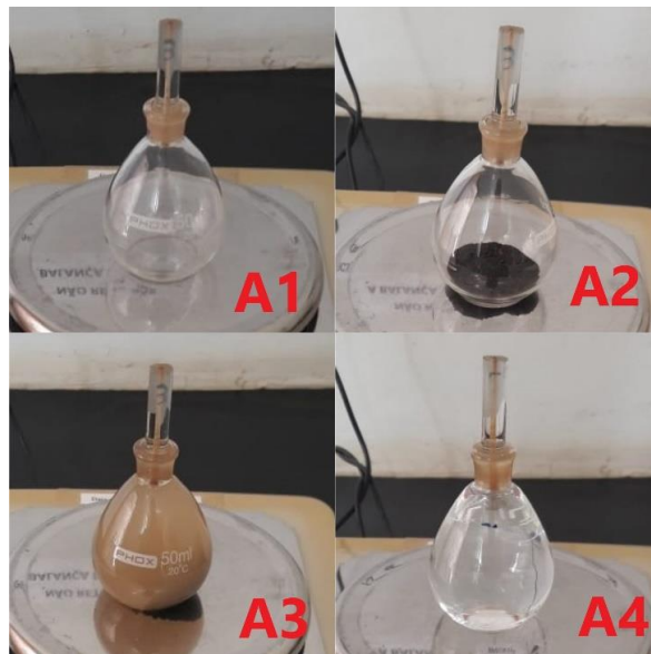
Figura 33 - Pesagens nos testes de picnometria
