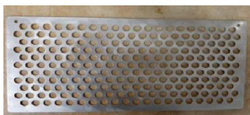
Figura 27: Eletrodo perfurado de aço inox Fonte: (FERREIRA, 2016)
