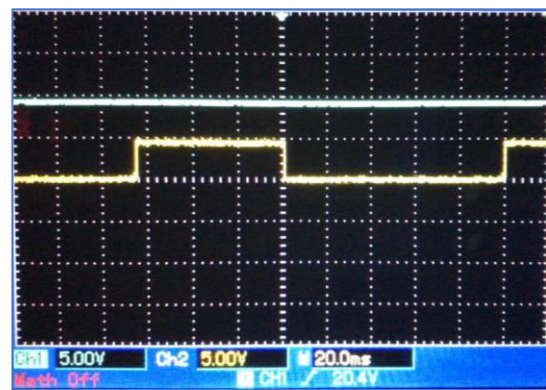
Figura 52: Ondas resultantes de 40% do PWM
