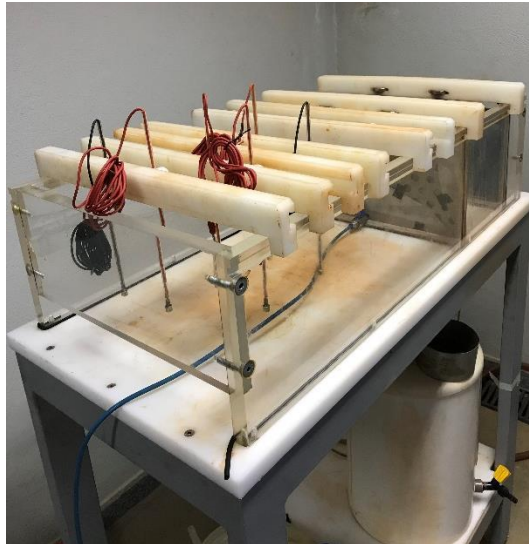
Figura 24: Célula eletrocinética Fonte: (RONZANI, 2018)
