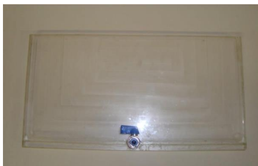
Figura 28: Suporte do eletrodo, com a válvula de vazão Fonte: (Ferreira, 2016)
