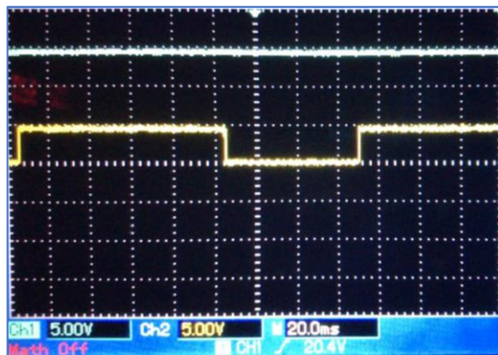
Figura 53: Ondas resultantes de 60% do PWM
