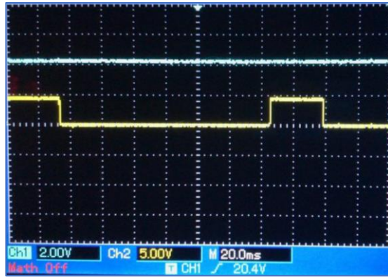
Figura 51: Ondas resultantes de 20% do PWM
