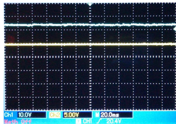
Figura 55: Ondas resultantes de 100% do PWM
