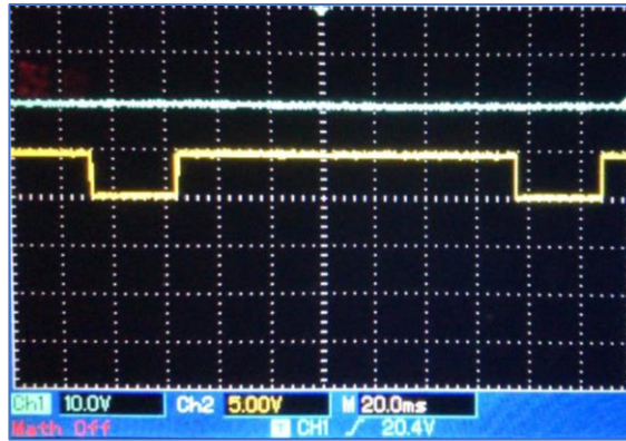
Figura 54: Ondas resultantes de 80% do PWM
