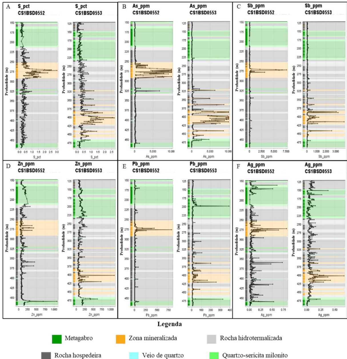
Figura 4.13 - Log geoquímico dos elementos maior correlação positiva a Au dentro dos intervalos mineralizados.
