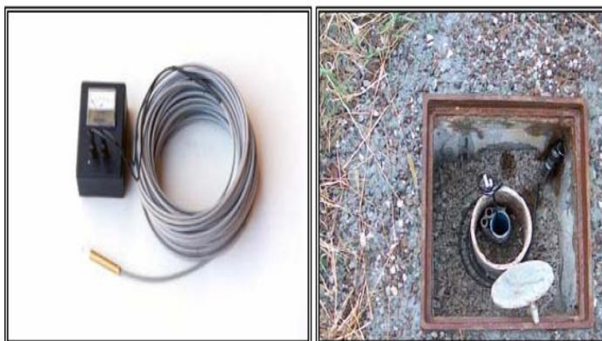
Figura 5: Medidor do nível de água para piezômetros de tubo aberto
