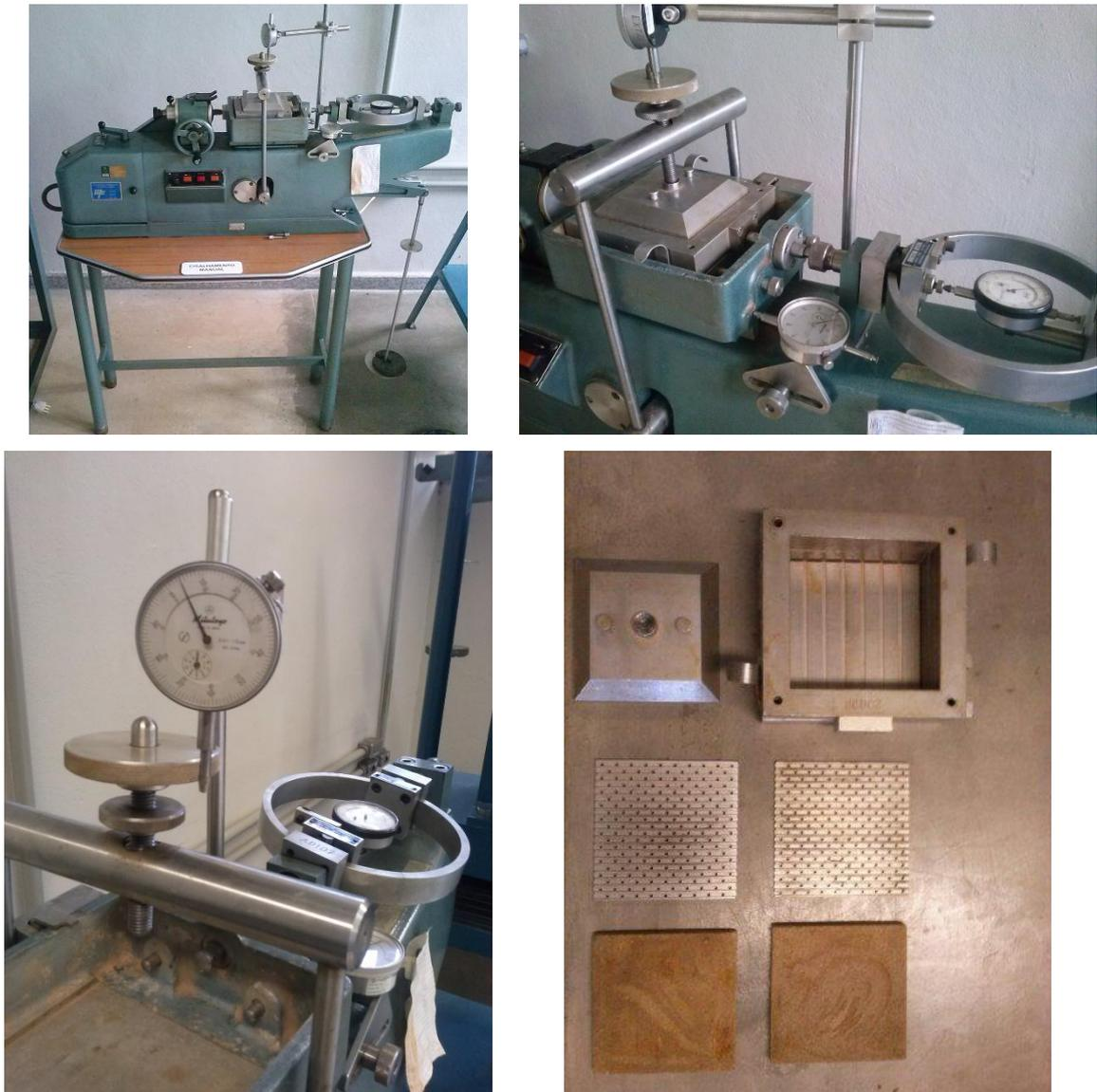
Dentre as etapas do ensaio descrito por norma, a colocação do corpo de prova na caixa de cisalhamento teve um cuidado especial devido a presença de raízes. Para uma melhor simulação das condições reais de campo, as raízes não foram cortadas rente à altura da caixa de cisalhamento, conforme ilustra a figura 3.7,
