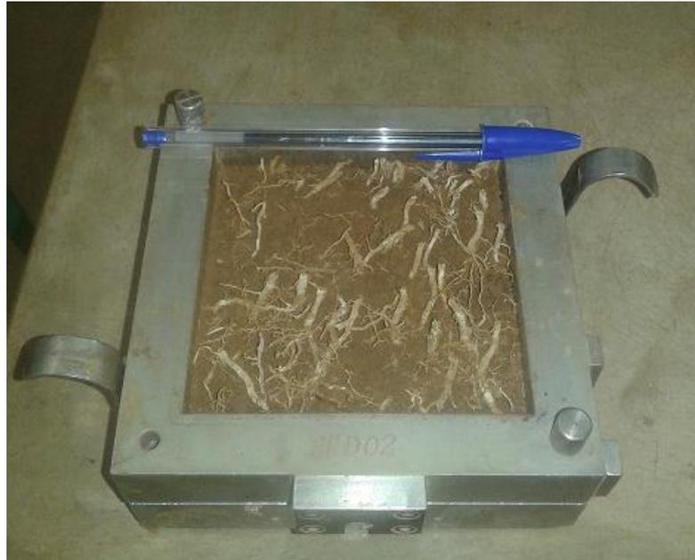
Foram adotados ensaios de cisalhamento direto sob velocidade controlada, de 0,4mm/s, por ser essa uma velocidade baixa. Não foram realizados ensaios com corpos de prova inundados. A montagem da caixa de cisalhamento foi realizada com as pedras porosas, como descreve a norma, para evitar a perda de solo no decorrer do ensaio e evitar também que as raízes saíssem pelos orifícios das placas, fato que aconteceria caso fossem utilizadas placas serrilhadas.
