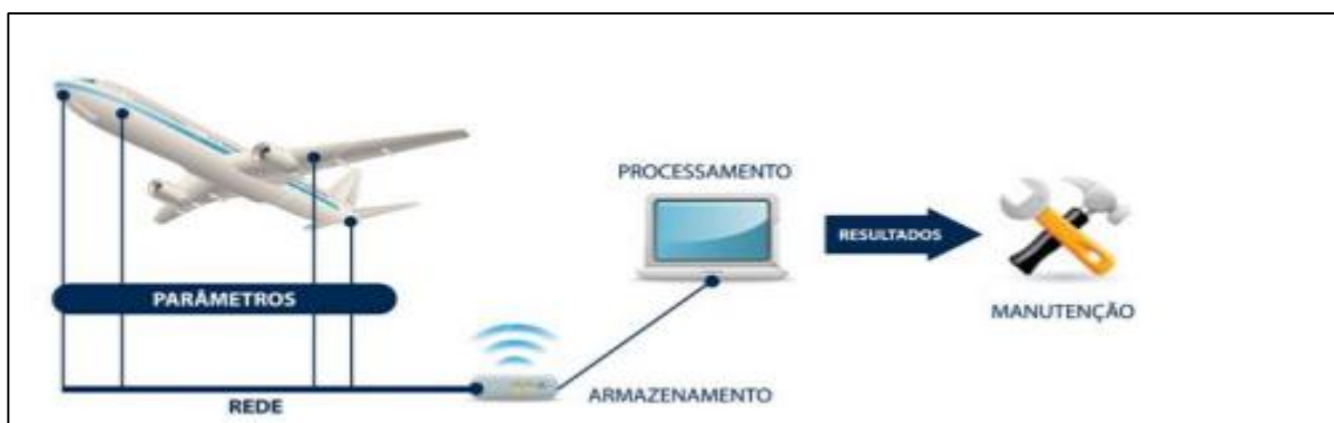
Figura 18: Diagrama processos de manutenção baseada em condição
